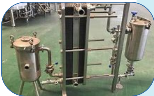
SISTEMA DE ENFRIADO DE AGUA AUTOMATIZADO PARA FERMENTACIÓN
